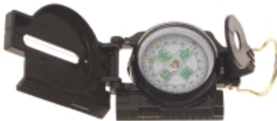
34023 Kompaß, US-Typ Metallgehäuse, flüssigkeitsgedämpft, präzisionsgelagert, übersichtliche Rose, Visiereinrichtung im Deckel, Vergrößerungsglas im Sucher MILITARY RANGER COMPASS WITH LIQUID, METAL
